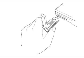
1. Inserte la tarjeta inalámbrica USB en un puerto USB 2.0 libre de su ordenador con éste encendido.
