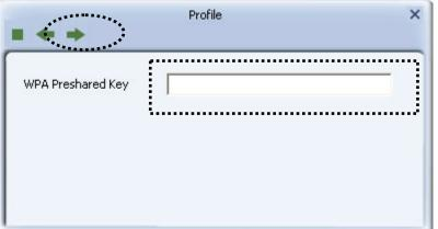
3. Si el punto de acceso inalámbrico utiliza encriptación, debe introducir la clave WEP o la clave WPA previamente compartida. Haga clic en la flecha derecha para continuar. Normalmente no tendrá que cambiar el método de encriptación, se detectará automáticamente.
